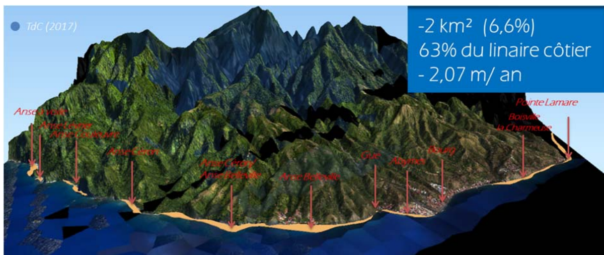
Figure 4. Bloc diagramme du recul du trait de côte au Prêcheur
